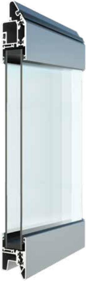
I profili in alluminio con taglio termico variano in modo significativo il valore termico della porta sezionale. Le porte FV con doppio acrilico trasparente e acrilico antigraffio vengono prodotte fino ai 6m di larghezza e 6m di altezza. Compatibilmente con le misure della porta può essere fornito anche il vetro camera.
